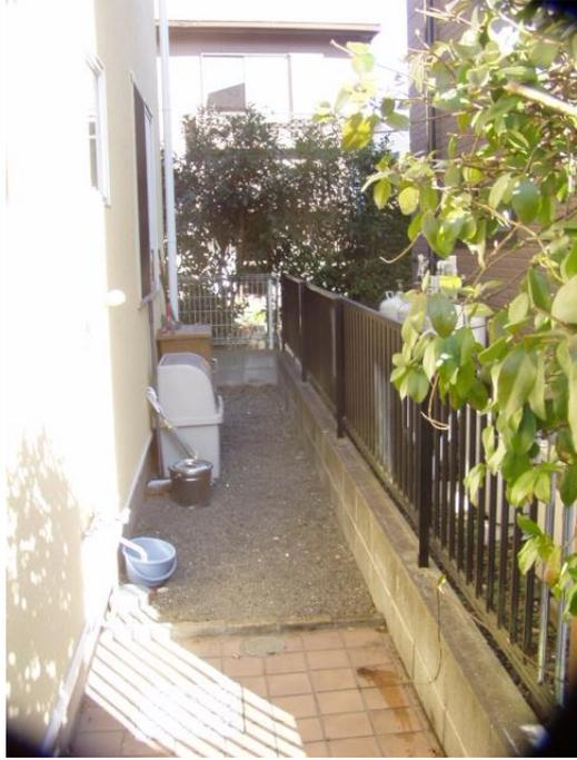
門扉サイズは $900^W \times 1200^H$ を設置しますが、柱と柱の間が狭く、扉を取り付ける前に40mmカットしてから設置します。
